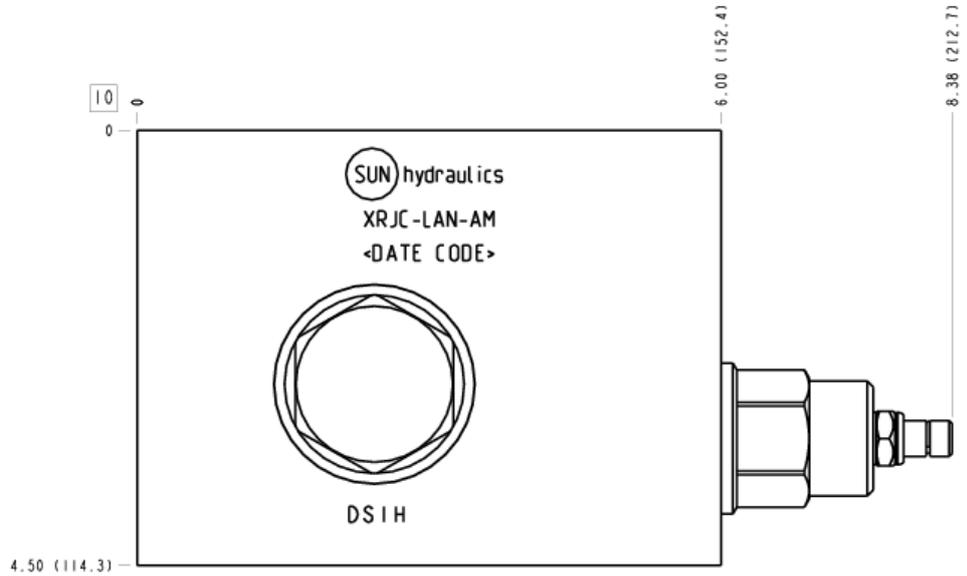
Ce bloc fournit un débit de rinçage pour les transmissions hydrostatiques. Le débit de rinçage permet d'évacuer de l'huile chaude depuis la ligne basse pression du circuit fermé. La pompe de gavage remplace l'huile chaude et polluée par de l'huile froide et filtrée. L'huile évacuée est également souvent utilisée pour traverser les carters de pompe et de moteur, les rinçant aussi de leur huile chaude et polluée.
