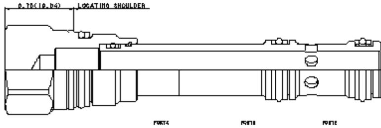
Der Verschlussstopfen verbindet Anschluss 1 mit 2 und Anschluss 3 mit 4.
