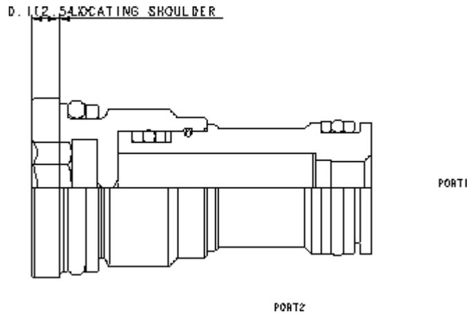
Dieser Verschlussstopfen ist bündig mit der Einschraubbohrung und sperrt alle Anschlüsse.
