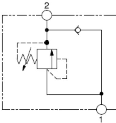
Diese Baugruppe bietet zwei Funktionen: Sie enthält ein Druckbegrenzungsventil, das von Anschluss 1 nach 2 öffnet, wenn die Einstellung erreicht ist und ein Umgehungsrückschlagventil, das einen Durchfluss von Anschluss 2 nach 1 ermöglicht.
