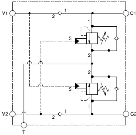
Cet ensemble permet le contrôle de l'inertie des charges entrainantes, la protection des lignes contre les surpressions, l'alimentation en huile régénérée et chasse l'huile chaude et polluée des récepteurs. Toute l'huile qui sort des récepteurs retourne au réservoir par l'orifice T.
