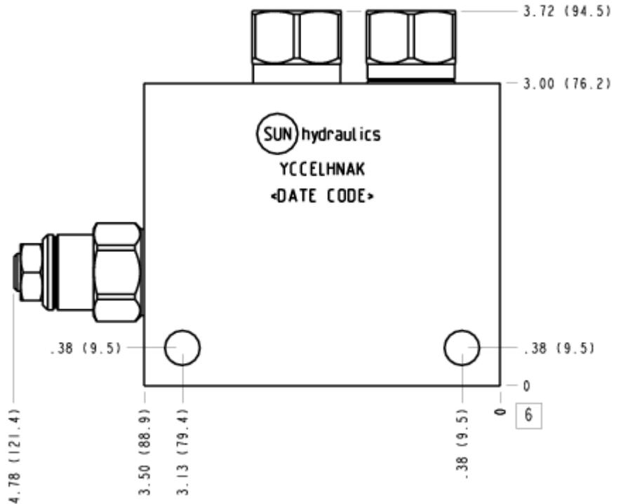
Diese Ventilkombination verhindert das Voreilen von negativen Lasten beim Absenken. Die Arbeitsanschlüsse sind gleichzeitig druckabgesichert und gut vor Kavitation geschützt (T-Anschluss erforderlich!). Das rückströmende, erhitzte und ggf. verschmutzte Öl vom Verbraucher wird entweder über den Arbeitsanschluss oder über den (optionalen) T-Anschluss geführt und bei jedem Arbeitsgang ausgespült.
