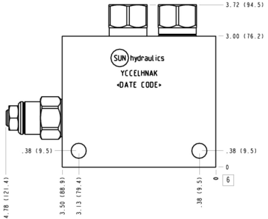
Diese Ventilkombination verhindert das Voreilen von negativen Lasten beim Absenken. Die Arbeitsanschlüsse sind gleichzeitig druckabgesichert und gut vor Kavitation geschützt (T-Anschluss erforderlich!). Das rückströmende, erhitze und ggf. verschmutzte Öl vom Verbraucher wird entweder über den Arbeitsanschluss oder über den (optionalen) T-Anschluss geführt und bei jedem Arbeitsgang ausgespült.
