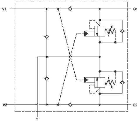
Cet ensemble permet le contrôle de l'inertie des charges entrainantes et la protection des lignes contre les surpressions. Le raccordement de l'orifice T qui est optionnel assurera l'alimentation en huile régénérée et pourra chasser l'huile chaude et polluée des récepteurs. L'huile qui sort des récepteurs peut retourner au réservoir soit par l'orifice T soit par le distributeur.
