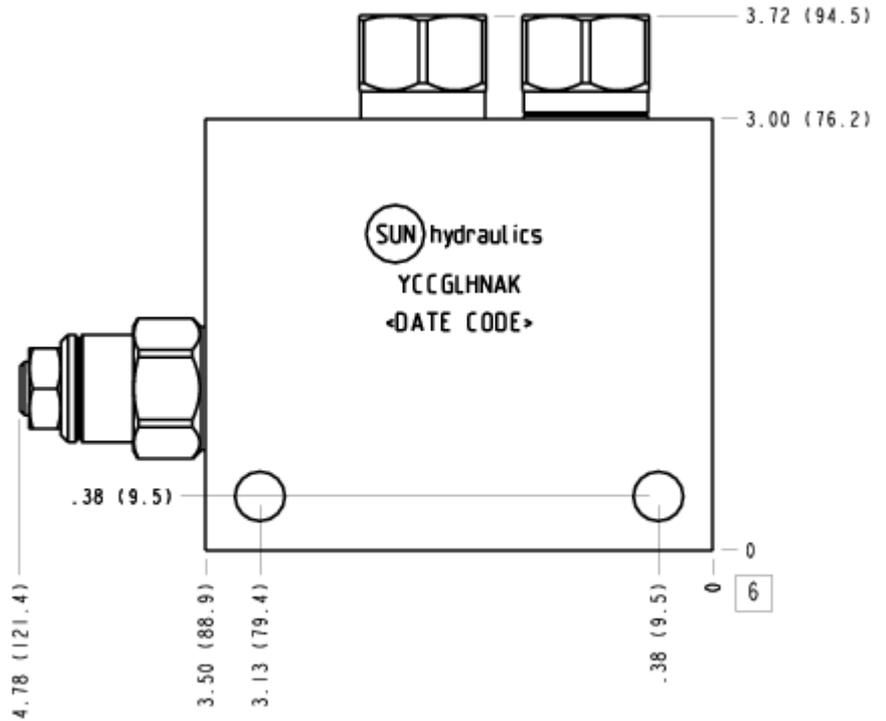
Cet ensemble permet le contrôle de l'inertie des charges entrainantes, la protection des lignes contre les surpressions et inclut un sélecteur de circuit pour libérer le frein. Le raccordement de l'orifice T qui est optionnel assurera l'alimentation en huile régénérée et pourra chasser l'huile chaude et polluée des récepteurs. L'huile qui sort des récepteurs peut retourner au réservoir soit par l'orifice T soit par le distributeur.
