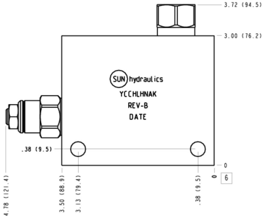
Diese Ventilkombination verhindert das Voreilen von negativen Lasten beim Absenken. Die Arbeitsanschlüsse sind gleichzeitig druckabgesichert und gut vor Kavitation geschützt. Das rückströmende, erhitzte und ggf. verschmutzte Öl vom Verbraucher wird zum T-Anschluss geführt und bei jedem Arbeitsgang ausgespült. Das integrierte Wechselventil meldet den Arbeitsdruck in Vorlaufichtung, der zum Öffnen einer Bremse oder als LS-Signal genutzt werden kann.
