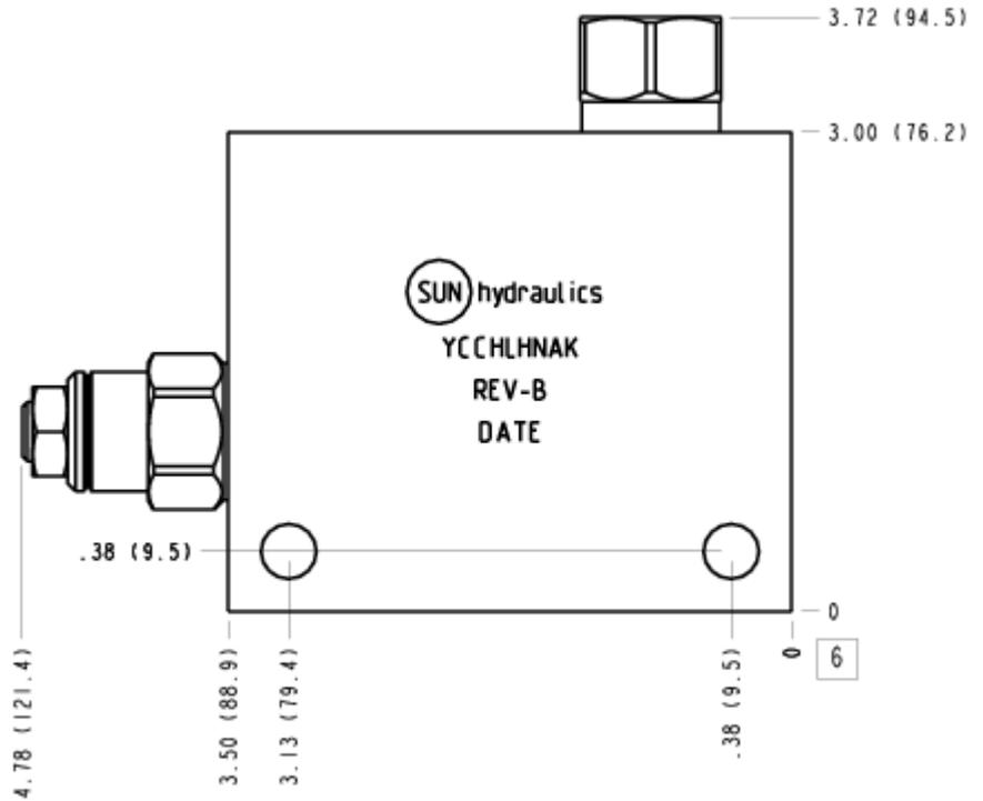
Cet ensemble permet le contrôle de l'inertie des charges entrainantes, la protection des lignes contre les surpressions, l'alimentation en huile régénérée, chasse l'huile chaude et polluée des récepteurs et inclut un sélecteur de circuit pour libérer le frein. Toute l'huile qui sort des récepteurs retourne au réservoir par l'orifice T.
