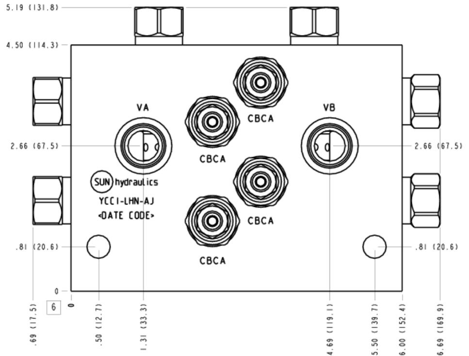
Diese Ventilkombination besteht aus einer Schwenkbremsschaltung und einem Stromteiler. Sie hat folgende Vorteile: Teilt zu zwei Abnehmern und vereinigt. Kontrolliert negative Lasten in beide Richtungen. Doppeldruckbegrenzung schützt vor Druckspitzen. Erlaubt thermische Druckentlastung. Verhindert Kavitation. Synchronisiert beide Stellglieder in den Endlagen in beiden Richtungen. Spült heißes/verschmutztes Öl aus dem Kreis.
