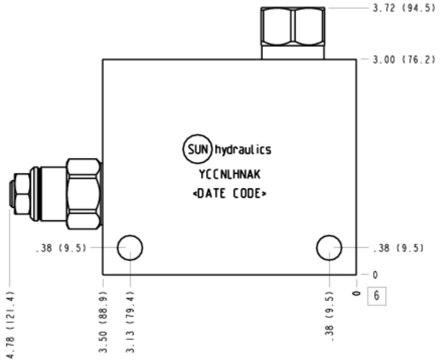
Diese Ventilkombination verhindert das Voreilen von negativen Lasten beim Absenken. Die Arbeitsanschlüsse sind gleichzeitig druckabgesichert und gut vor Kavitation geschützt. Das rückströmende, erhitzte und ggf. verschmutzte Öl vom Verbraucher wird zum T-Anschluss geführt bei jedem Arbeitsgang ausgespült.
