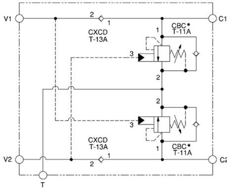
Cet ensemble permet le contrôle de l'inertie des charges entrainantes, la protection des lignes contre les surpressions, l'alimentation en huile régénérée et chasse l'huile chaude et polluée des récepteurs. Toute l'huile qui sort des récepteurs retourne au réservoir par l'orifice T.
