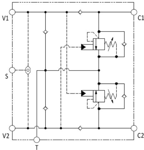
Cet ensemble permet le contrôle de l'inertie des charges entrainantes, la protection des lignes contre les surpressions et inclut un sélecteur de circuit pour libérer le frein. Le raccordement de l'orifice T qui est optionnel assurera l'alimentation en huile régénérée et pourra chasser l'huile chaude et polluée des récepteurs. L'huile qui sort des récepteurs peut retourner au réservoir soit par l'orifice T soit par le distributeur.
