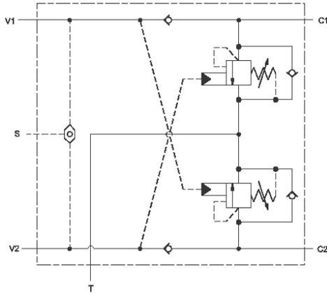
Cet ensemble permet le contrôle de l'inertie des charges entrainantes, la protection des lignes contre les surpressions, l'alimentation en huile régénérée, chasse l'huile chaude et polluée des récepteurs et inclut un sélecteur de circuit pour libérer le frein. Toute l'huile qui sort des récepteurs retourne au réservoir par l'orifice T.
