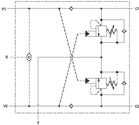
Diese Ventilkombination verhindert das Voreilen von negativen Lasten beim Absenken. Die Arbeitsanschlüsse sind gleichzeitig druckabgesichert und gut vor Kavitation geschützt. Das rückströmende, erhitzte und ggf. verschmutzte Öl vom Verbraucher wird zum T-Anschluss geführt und bei jedem Arbeitsgang ausgespült. Das integrierte Wechselventil meldet den Arbeitsdruck in Vorlaufrichtung, der zum Öffnen einer Bremse oder als LS-Signal genutzt werden kann.
