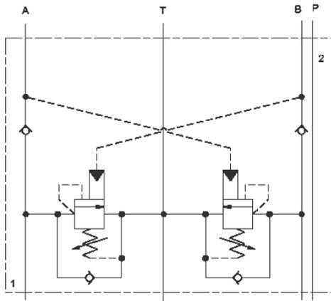
Cet ensemble permet le contrôle de l'inertie des charges entrainantes, la protection des lignes contre les surpressions, l'alimentation en huile régénérée et chasse l'huile chaude et polluée des récepteurs. Toute l'huile qui sort des récepteurs retourne au réservoir par l'orifice T.
