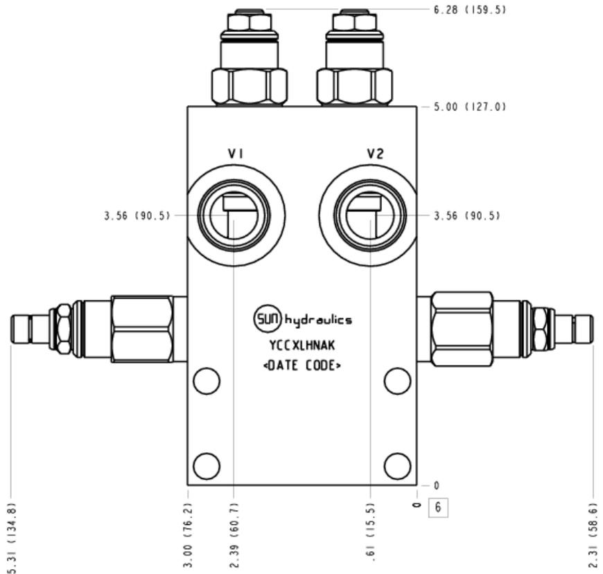
Diese Baugruppe enthält zwei Funktionen, a) Doppelte Lasthaltung in den Motoranschlüssen M1 und M2 und b) Doppelschockfunktion zwischen den Anschlüssen M1 und M2.
