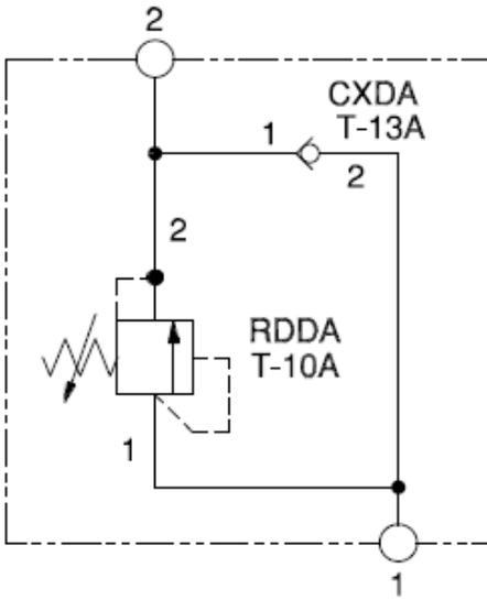
Cet ensemble assure 2 fonctions : Lorsque la pression à l'orifice 1 excède le tarage de la valve il limite la pression en dérivant du débit de l'orifice 1 vers le réservoir (orifice 2) . Et il incorpore un clapet anti-retour qui permet un libre passage dans le sens inverse (de 2 vers 1).
