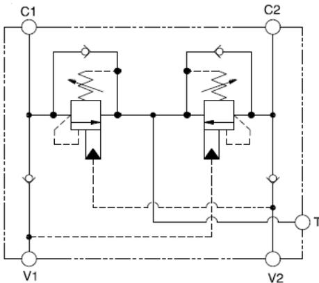
**NOTES:** • **Important:** La pression maximum du système doit être considérée avec une grande attention. La limite de pression maximum à laquelle le bloc peut être utilisé dépend de la matière du bloc, alors que le type et la dimension des orifices sont secondaires. Les blocs forés fabriqués en aluminium ne sont pas prévus pour des pressions supérieures à 210 bar (3000 psi), et ce quelles que soient les types et dimensions des orifices spécifiés.
