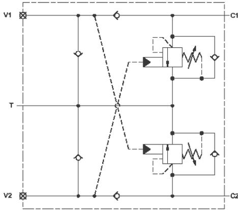
Cet ensemble permet le contrôle de l'inertie des charges entrainantes et la protection des lignes contre les surpressions. Le raccordement de l'orifice T qui est optionnel assurera l'alimentation en huile régénérée et pourra chasser l'huile chaude et polluée des récepteurs. L'huile qui sort des récepteurs peut retourner au réservoir soit par l'orifice T soit par le distributeur.
