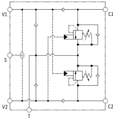
Cet ensemble permet le contrôle de l'inertie des charges entraînant, la protection des lignes contre les surpressions et inclut un sélecteur de circuit pour libérer le frein. Le raccordement de l'orifice T qui est optionnel assurera l'alimentation en huile régénérée et pourra chasser l'huile chaude et polluée des récepteurs. L'huile qui sort des récepteurs peut retourner au réservoir soit par l'orifice T soit par le distributeur.
