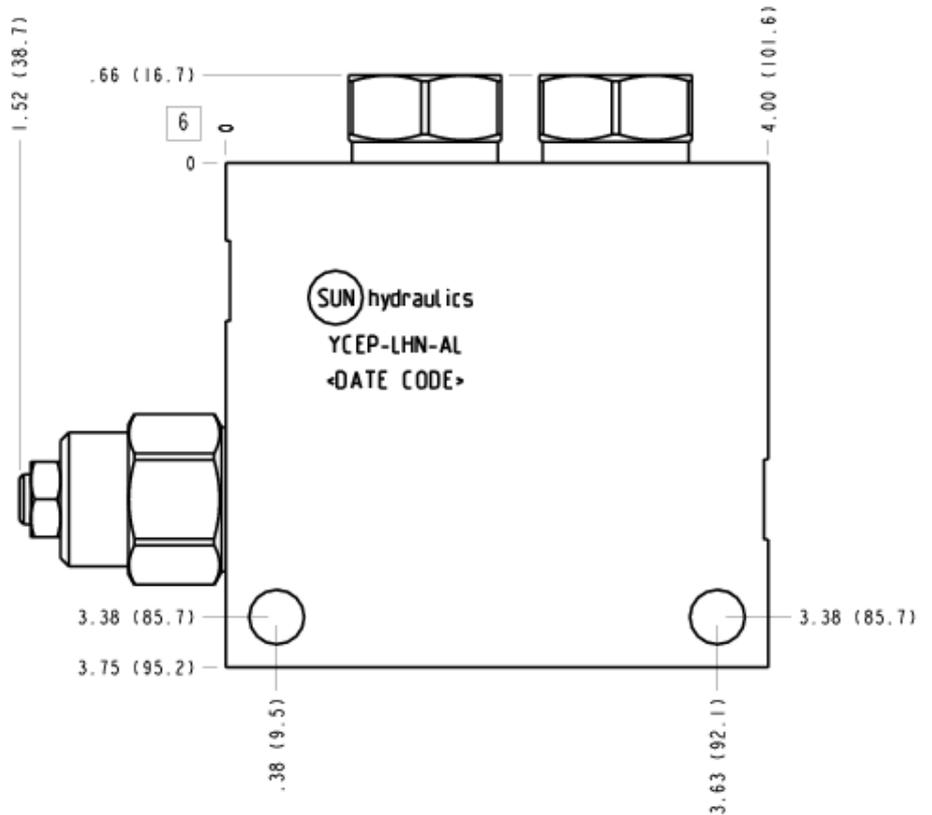
Diese Ventilkombination verhindert das Voreilen von negativen Lasten beim Absenken. Die Arbeitsanschlüsse sind gleichzeitig druckabgesichert und gut vor Kavitation geschützt. Das rückströmende, erhitzte und ggf. verschmutzte Öl vom Verbraucher wird zum T-Anschluss geführt bei jedem Arbeitsgang ausgespült.
