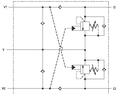
Cet ensemble permet le contrôle de l'inertie des charges entraînant, la protection des lignes contre les surpressions, l'alimentation en huile régénérée et chasse l'huile chaude et polluée des récepteurs. Toute l'huile qui sort des récepteurs retourne au réservoir par l'orifice T.
