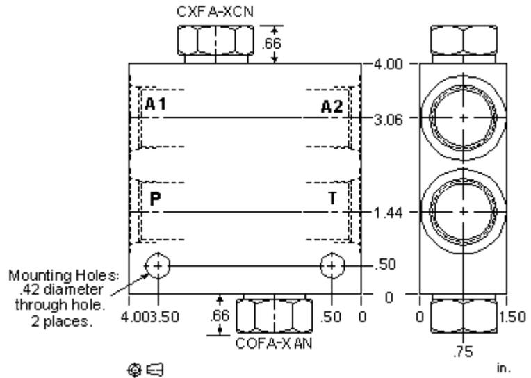
Cet ensemble va décharger automatiquement un accumulateur au travers d'un gicleur de 3,3 mm (0.125 in) chaque fois que la pompe s'arrêtera. Chaque fois que la pompe est démarrée, le clapet piloté se ferme, en bloquant le passage vers le réservoir. Le clapet simple empêche l'huile contenue dans l'accumulateur de retourner à travers la pompe.
