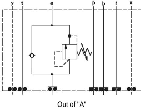
Diese Zwischenplattenbaugruppe begrenzt den Druck in A, sobald der am Ventil eingestellte Druck überschritten ist. Sie enthält zusätzlich ein Umgehungsrückschlagventil.
