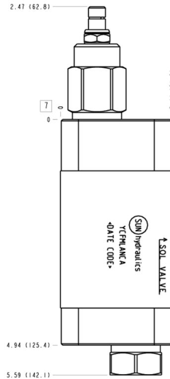
Diese Baugruppe besteht aus einem direkt gesteuerten, im Ruhezustand geschlossenen Druckbegrenzungsventil und einem Umgehungsrückschlagventil.
