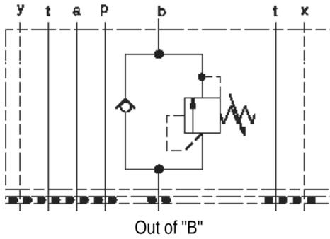
Diese Baugruppe besteht aus einem direkt gesteuerten, im Ruhezustand geschlossenen Druckbegrenzungsventil und einem Umgehungsrückschlagventil.
