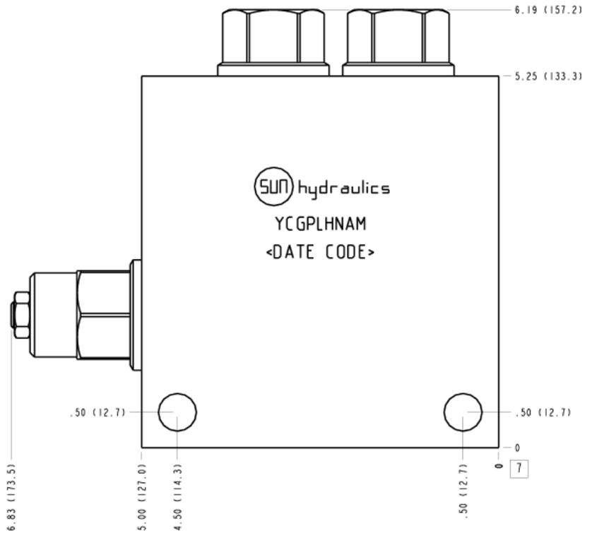
Diese Ventilkombination verhindert das Voreilen von negativen Lasten beim Absenken. Die Arbeitsanschlüsse sind gleichzeitig druckabgesichert und gut vor Kavitation geschützt. Das rückströmende, erhitze und ggf. verschmutzte Öl vom Verbraucher wird zum T-Anschluss geführt und bei jedem Arbeitsgang ausgespült. Das integrierte Wechselventil meldet den Arbeitsdruck in Vorlaufrichtung, der zum Öffnen einer Bremse oder als LS-Signal genutzt werden kann.
