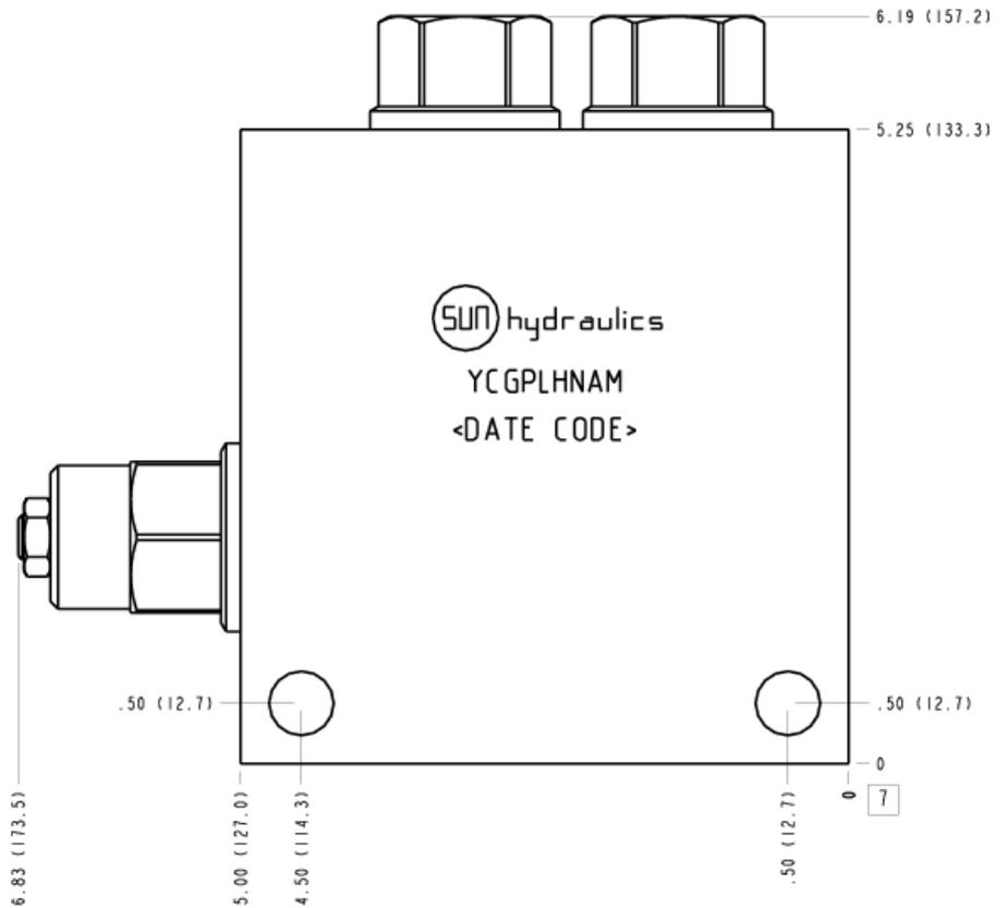
Diese Ventilkombination verhindert das Voreilen von negativen Lasten beim Absenken. Die Arbeitsanschlüsse sind gleichzeitig druckabgesichert und gut vor Kavitation geschützt. Das rückströmende, erhitzte und ggf. verschmutzte Öl vom Verbraucher wird zum T-Anschluss geführt und bei jedem Arbeitsgang ausgespült. Das integrierte Wechselventil meldet den Arbeitsdruck in Vorlaufichtung, der zum Öffnen einer Bremse oder als LS-Signal genutzt werden kann.
