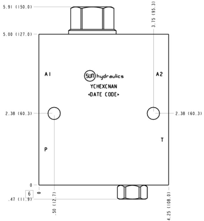
Cet ensemble va décharger automatiquement un accumulateur au travers d'un gicleur de 3,3 mm (0.125 in) chaque fois que la pompe s'arrêtera. Chaque fois que la pompe est démarrée, le clapet piloté se ferme, en bloquant le passage vers le réservoir. Le clapet simple empêche l'huile contenue dans l'accumulateur de retourner à travers la pompe.
