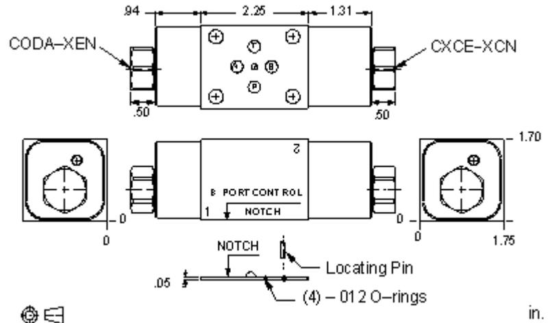
Le bloc différentiel permanent permet de sortir la tige d'un vérin double effet plus rapidement qu'avec le seul débit de la pompe. Pour ce faire, l'huile sortant du côté tige du vérin est additionnée au débit de la pompe pour alimenter le côté fond du vérin, ce qui augmente la vitesse de sortie.
