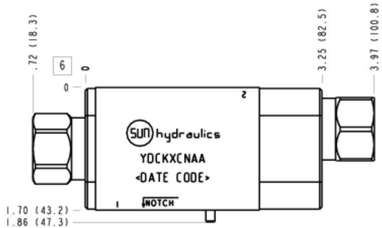
Le bloc différentiel permanent permet de sortir la tige d'un vérin double effet plus rapidement qu'avec le seul débit de la pompe. Pour ce faire, l'huile sortant du côté tige du vérin est additionnée au débit de la pompe pour alimenter le côté fond du vérin, ce qui augmente la vitesse de sortie.
