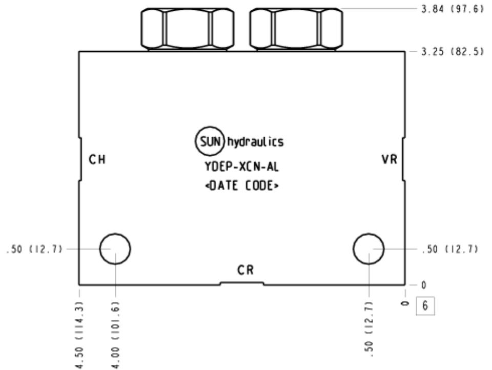
Le bloc différentiel permanent permet de sortir la tige d'un vérin double effet plus rapidement qu'avec le seul débit de la pompe. Pour ce faire, l'huile sortant du côté tige du vérin (CR) est additionnée au débit de la pompe (VH) pour alimenter le côté fond du vérin (CH), ce qui augmente la vitesse de sortie. VR est connecté au côté tige du distributeur.
