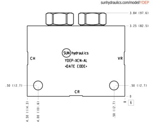
Le bloc différentiel permanent permet de sortir la tige d'un vérin double effet plus rapidement qu'avec le seul débit de la pompe. Pour ce faire, l'huile sortant du coté tige du vérin (CR) est additionnée au débit de la pompe (VH) pour alimenter le coté fond du vérin (CH), ce qui augmente la vitesse de sortie. VR est connecté au côté tige du distributeur .
