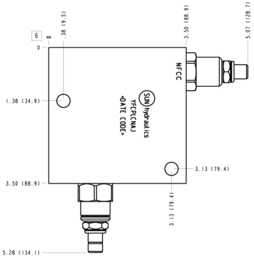
Diese Baugruppe enthält eine 3-Wege-Druckwaage. Sie ist ein in der Ruhestellung geschlossenes Regelelement mit Druckbegrenzungsfunktion, das zusammen mit einer externen Blende zwei Funktionen erfüllt: Der Hauptkolben der 3-Wege-Druckwaage hält die Druckdifferenz über die externe Blende konstant. Überschüssiger Volumenstrom wird zum Tank (Anschluss 2) abgeführt. Bei Erreichen des Druckeinstellwerts verhält sich das Ventil wie ein normales Druckbegrenzungsventil.
