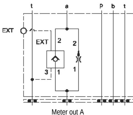
Diese Baugruppe enthält einen Stromregler mit Festblende, der eine genaue Zulauf- oder Ablaufregelung bei hohen Druckschwankungen erlaubt. Die Einstellung des Durchflusses muss vom Kunden festgelegt werden und wird im Werk durchgeführt. Die Vorschubrate wird mit einem entsperren, entlasteten Rückschlagventil mit externem Steueranschluss ausgewählt.
