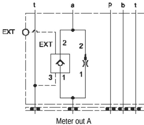
Cet ensemble consiste en un régulateur de débit à orifice fixe, compensé en pression. Il se caractérise par une régulation de débit précise, pour des applications en entrée ou en sortie de récepteur, où d'importantes fluctuations de la pression peuvent se produire. Le réglage du débit est à spécifier par le client et il est réalisé en usine par nos soins. La vitesse rapide ou la vitesse de travail est sélectionnée par un clapet piloté drainé muni d'un orifice de pilotage externe.
