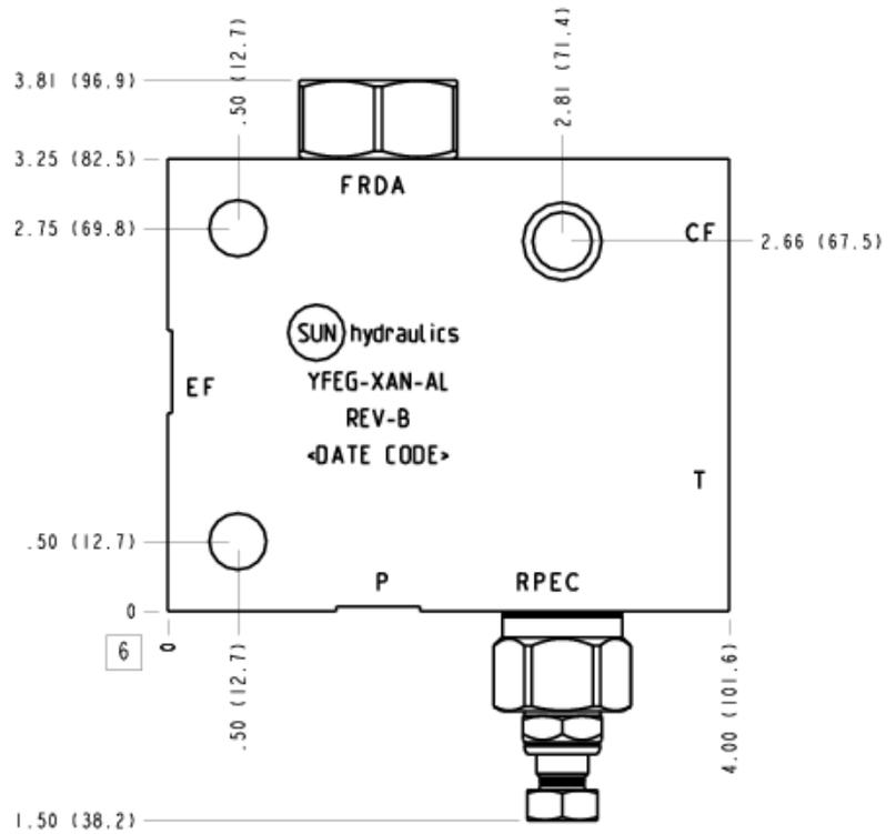
Diese Baugruppe enthält einen 3-Wege Vorzugsstromregler mit Festblende. Anschluss P ist der Einlass und Anschluss CF (Controlled Flow) der geregelte Auslass. Wenn die Bedingungen für den Vorzugsstrom erfüllt sind, wird der überschüssige Volumenstrom zum Anschluss EF (Excessive Flow) umgeleitet. Dieser Bypassvolumenstrom kann in einem zweiten Kreis genutzt werden. Ein Druckbegrenzungsventil schützt den geregelten Auslass gegen Überdruck und entlastet CF nach T.
