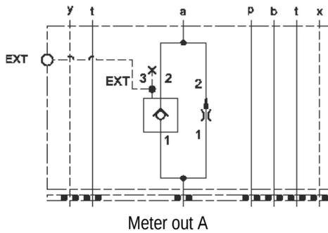
Cet ensemble consiste en un régulateur de débit à orifice fixe, compensé en pression. Il se caractérise par une régulation de débit précise, pour des applications en entrée ou en sortie de récepteur, où d'importantes fluctuations de la pression peuvent se produire. Le réglage du débit est à spécifier par le client et il est réalisé en usine par nos soins. La vitesse rapide ou la vitesse de travail est sélectionnée par un clapet piloté muni d'un orifice de pilotage externe.
