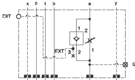
Cet ensemble consiste en un étrangleur à pointeau pleine plage, utilisé pour régler le débit. Il est réglable à l'infini de complètement fermé jusqu'au diamètre maxi. Il n'est pas compensé en pression. Il peut servir à régler un débit ou bien à le fermer comme avec un robinet. La vitesse rapide ou la vitesse de travail est sélectionnée par un clapet piloté drainé muni d'un orifice de pilotage externe.
