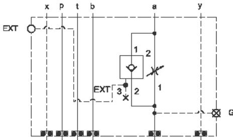
Diese Baugruppe enthält eine Drossel mit voll verstellbarer Blende, mit der Volumenströme reguliert werden können. Die Blende kann frei verstellt werden von vollständig geschlossen bis zum maximalen Blendendurchmesser. Die Drossel ist nicht druckkompensiert. Sie kann zum Einstellen von Volumenströmen oder als Absperrventil benutzt werden. Die Vorschubrate wird mit einem entlasteten, entsperrenbaren Rückschlagventil mit externem Steueranschluss ausgewählt.
