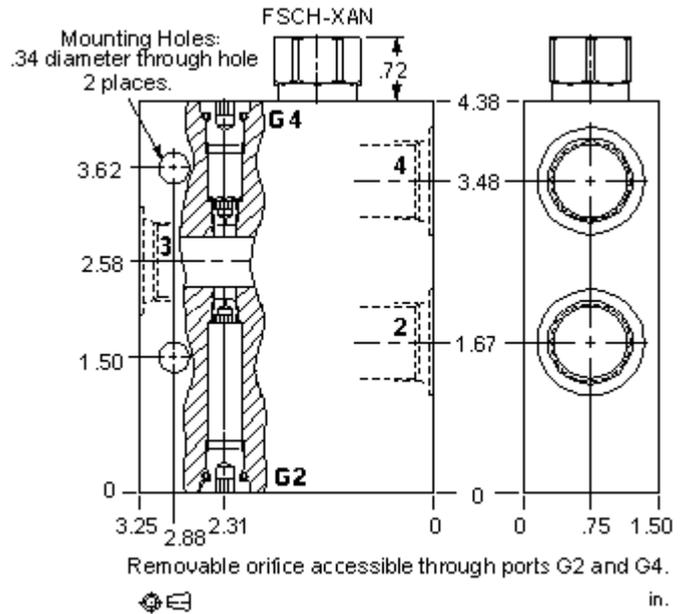
Diese Ventilkombination ist für Antriebssysteme mit Schlupf vorgesehen. Es beinhaltet einen Stromteiler/Vereiniger und die Möglichkeit, Blenden für den Ausgleich von Schlupf einzusetzen. Für den Antrieb teilt der Stromteiler/Vereiniger den Volumenstrom genau auf, und die Blenden für den Schlupf können an den Bedarf der Lenkung angepasst werden.
