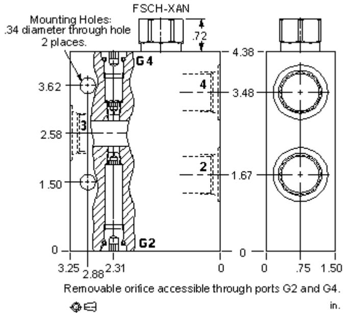
Ce bloc est utilisé dans les systèmes de transmission. Il incorpore un diviseur/réunisseur ainsi qu'une prédisposition pour des gicleurs de différentiel. Le diviseur/réunisseur génère deux débits égaux pour garantir la traction et les orifices peuvent être dimensionnés en tenant compte du braquage.
