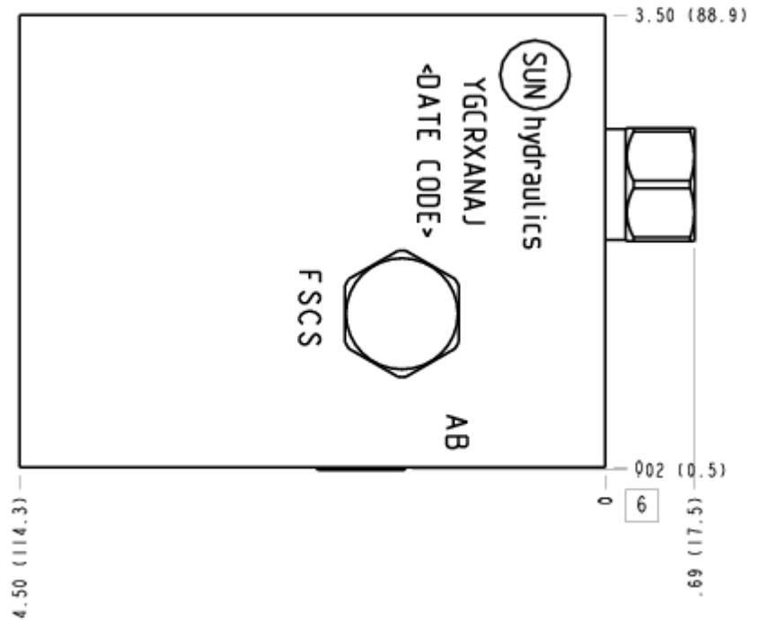
Diese Stromteiler/Vereiniger-Ventilkombination teilt und vereint vier Volumenströme gleichmäßig in beide Richtungen. Beim Teilen wird der Volumenstrom vom Anschluss AB nach A1, A2, B1 und B2 gleichmäßig aufgeteilt. Beim Vereinigen werden die Volumenströme von A1, A2, B1 und B2 nach AB auf gleiche Größe gedrosselt. Endlagenausgleich in beiden Richtungen ist mit dieser Ventilkombination möglich.
