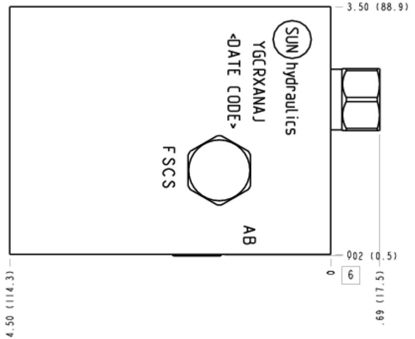
Ce bloc rassemble 3 diviseurs/réunisseurs générant 4 débits bidirectionnels égaux. Dans le mode diviseur, le débit entrant dans AB est divisé en 4 débits égaux sortant de A1, A2, B1, B2. Dans le mode réunisseur, les 4 débits entrant dans A1, A2, B1, B2 sont étranglés pour être maintenus égaux. Ce bloc permet de corriger en butée de fin de course des écarts d'alignement dans les 2 sens de marche.
