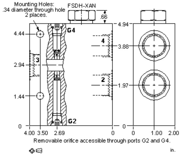
Ce bloc est utilisé dans les systèmes de transmission. Il incorpore un diviseur/réunisseur ainsi qu'une prédisposition pour des gicleurs de différentiel. Le diviseur/réunisseur génère deux débits égaux pour garantir la traction et les orifices peuvent être dimensionnés en tenant compte du braquage.
