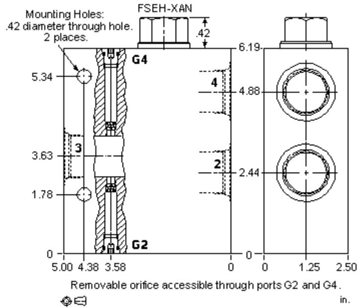
Diese Ventilkombination ist für Antriebssysteme mit Schlupf vorgesehen. Es beinhaltet einen Stromteiler/Vereiniger und die Möglichkeit, Blenden für den Ausgleich von Schlupf einzusetzen. Für den Antrieb teilt der Stromteiler/Vereiniger den Volumenstrom genau auf, und die Blenden für den Schlupf können an den Bedarf der Lenkung angepasst werden.
