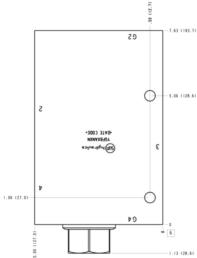
Ce bloc est utilisé dans les systèmes de transmission. Il incorpore un diviseur/réunisseur ainsi qu'une prédisposition pour des gicleurs de différentiel. Le diviseur/réunisseur génère deux débits égaux pour garantir la traction et les orifices peuvent être dimensionnés en tenant compte du braquage.
